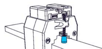
Cappuccio di protezione per vite fissaggio cod. 9SAMCP Protective caps for CT fixing cod. 9SAMCP
